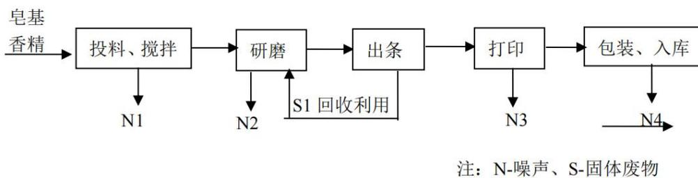
图 3.7 香皂产品生产工艺流程及产污环节图
