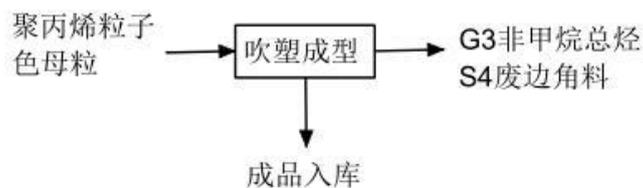
图 3.5 吹瓶生产工艺流程及产污环节图
