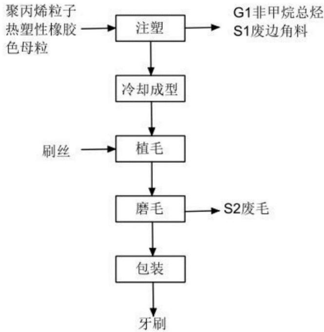
图 3.3 牙刷生产工艺流程及产污环节图
