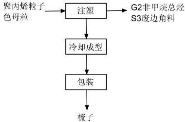
图 3.4 梳子生产工艺流程及产污环节图
