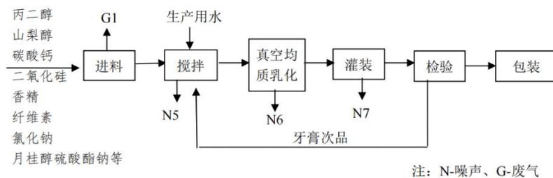
图 3.8 牙膏产品生产工艺流程及产污环节图
