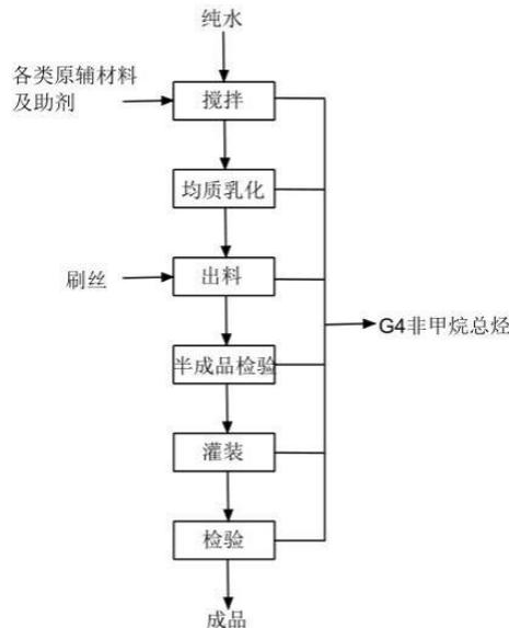
图 3.6 洗发沐浴产品生产工艺流程及产污环节图
